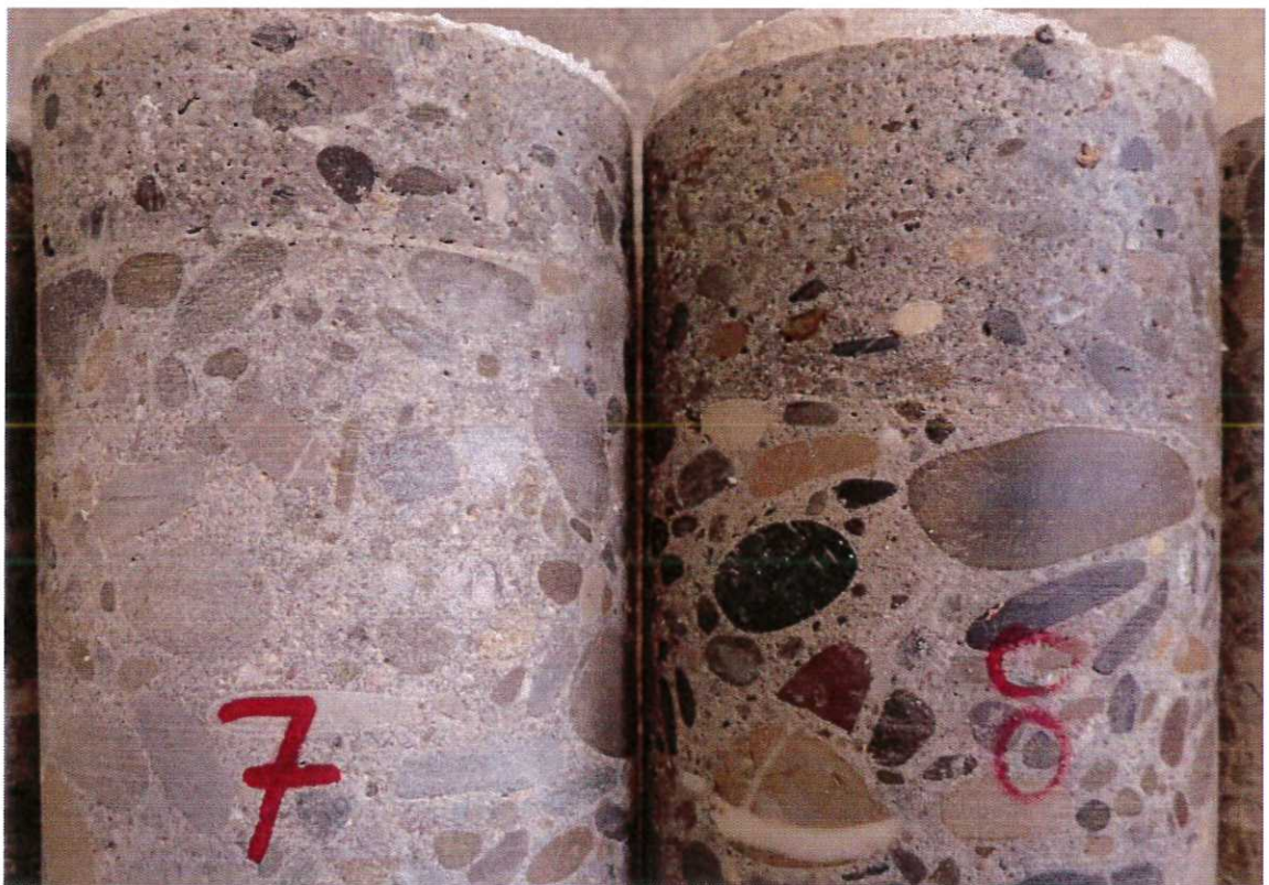
Bohrkerne aus Boden mit Gefälleestrich.
